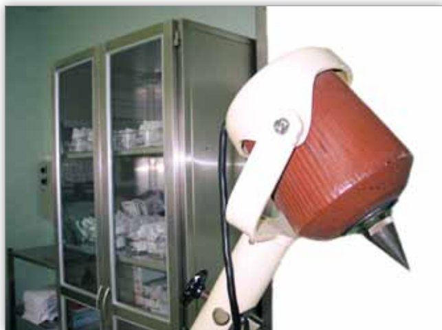
Ryc. 1. Elektromagnes służący do usuwania ciał obcych magnetycznych – blok operacyjny Kliniki Okulistyki UM w Białymstoku. Fig. 1. Electromagnet for magnetic foreign bodies extraction – surgery theatre of Ophthalmology Department in Białystok.
