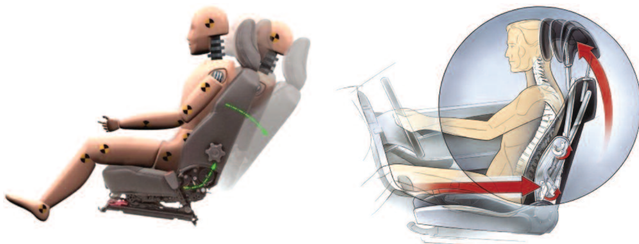
Ryc. 3. Zasada działania Anti-Whiplash Seat firmy Autoliv (po lewej) oraz aktywnego zagłówka SAHR firmy Saab (po prawej).
